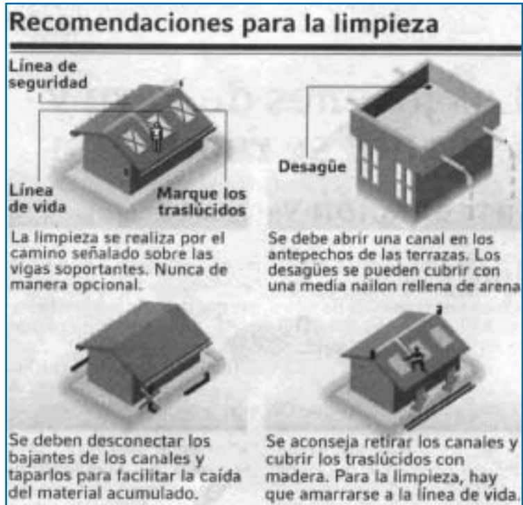
Figura D.2 Información sobre el procedimiento de limpieza de cubiertas con el fin de evitar accidentes.
